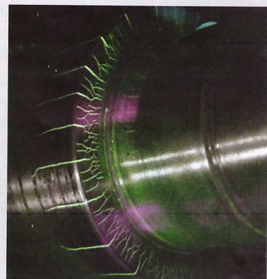
Bild 11. Indikationer på sprickförekomst i magnetpulverprovad komponent.
