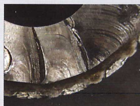
Bild 8. Tre (av totalt fyra) utmattningssprickor som har propagerat simultant genom startaxelns gods.
