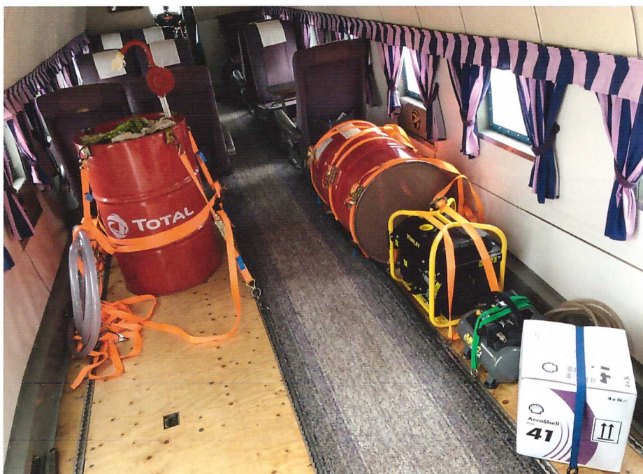
C-47:ans motorer kräver tjock motorolja, som kan vara bristvara längs färdvägen. Därför medfördes två stora oljefat, fastsurrade i kabinen.. Foto Patrik Molander.
