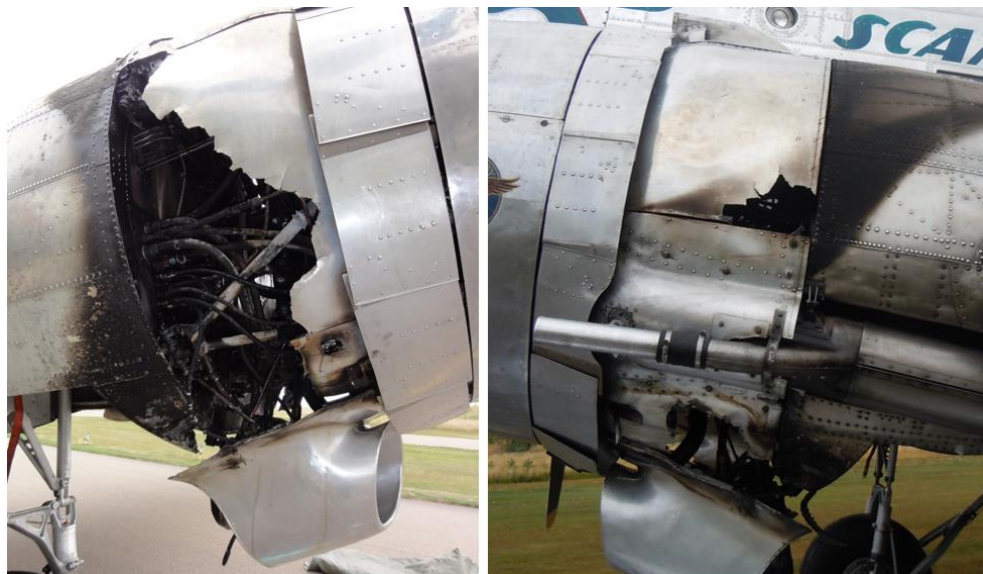
Figur 7. Brandskador på kåporna runt zon 2 på vänster motor. I kåporna bakom zon 2 fanns det några mindre hål där lättmetallen smält.
