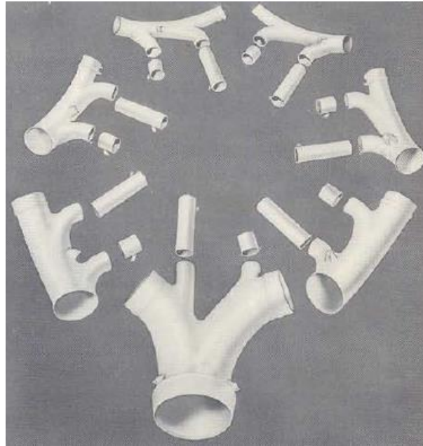
Figur 3. Avgassamlarens sju sektioner med huvudsektionen längst ner i bild.
