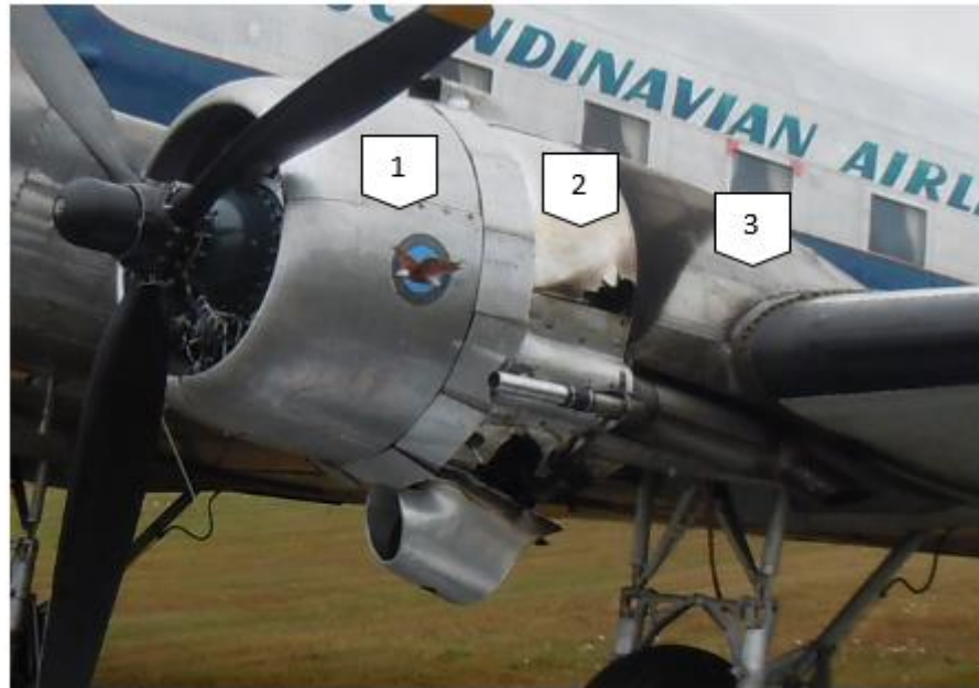
Figur 2. Motorgondolen med de tre huvuddelarna: zon 1 – motorutrymme, zon 2 – apparatrum och zon 3 – utrymme för oljetank och landningsställ. På bilden syns också sot från en del av lågorna och smältskador på kåpor över apparatrummet.
